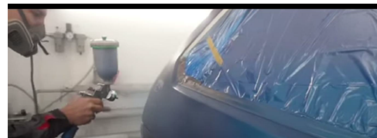
Рисунок 2 – Нанесение защитной пленки ксиломида
